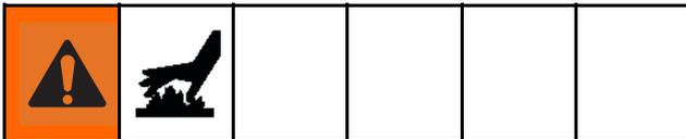
Um die Gefahr von Verbrennungen zu vermeiden, nehmen Sie am Kühlmittelsystem keine Wartungsmaßnahmen vor, bis dieses die Umgebungstemperatur erreicht hat.
